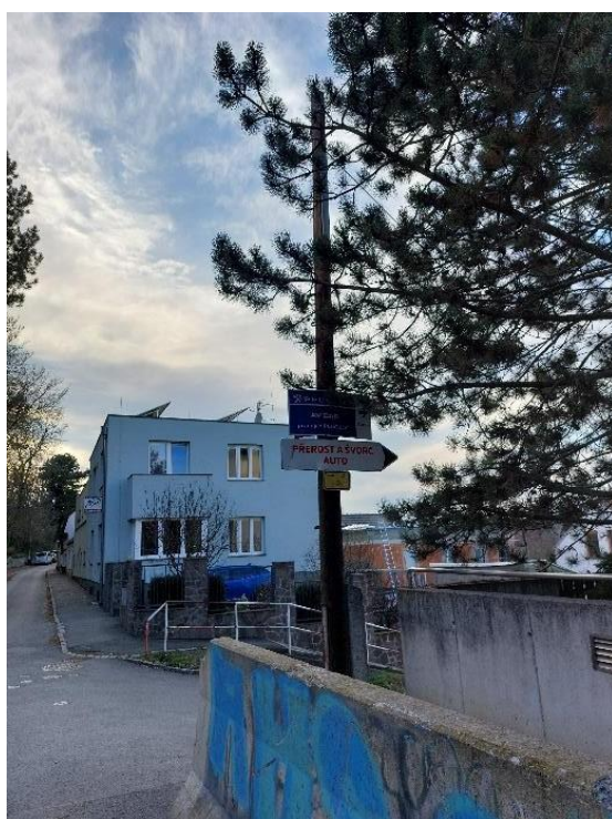
Obrázek 2.11: Svodidlo zakrývající rozhledy v křižovatce.
