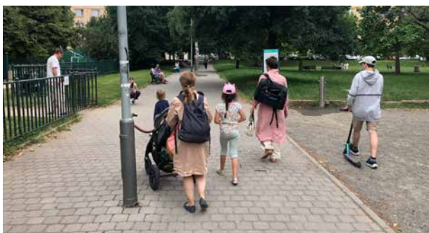
Sloupy veřejného osvětlení jsou umístěné v pěší ose S-J. Typ VO/lampy nevyhovuje současným trendům pro veř. osvětlení, světlo jde do oken bytů.
